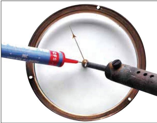
Afb. 88. Solderen van de tendenswijzer aan het draaiknopje in het glas.
