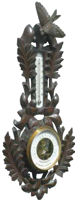
Afb. 22. Knap met de hand uit lindenhout gestoken, in Duitsland (waarschijnlijk Schwarzwald) voor de Nederlandse markt vervaardigde, aneroïde barometer hier met een vogeltje bekroond. Typerend voor de tweede helft van de 19e eeuw.
