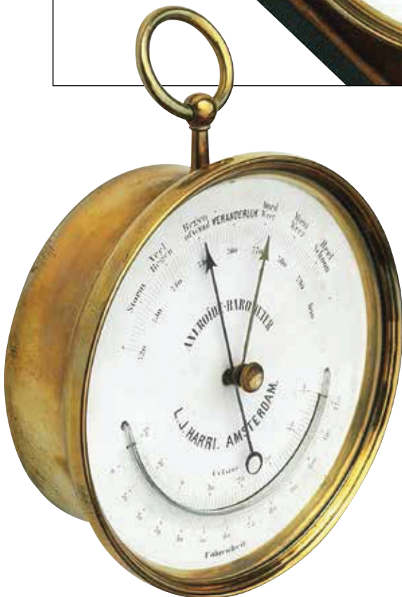
Afb. 105. Zeer oude Nederlandse koperen barometer in bijbehorende doos van de nog altijd bestaande (sinds 1730!) Amsterdamse instrumentmaker/leverancier L. J. Harri gevestigd in de Schreierstoren. Circa 1844-1850, diameter \varnothing 123 mm. Op wit glanskarton gedrukte barometer- en thermometerschaal met weersaanwijdingen, luchtdrukwaarden in mm. kwik en temperaturen in celsius en fahrenheit. Uiterst dunne gebogen kwikthermometer.
